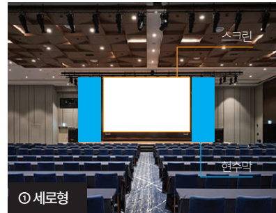
규 격 | 2.15(W) x 6.4(H) m x 2장 (좌, 우) 설치 위치 | LED 전광판 앞 / 스크린 뒤 설치 방법 | 바텐 자석 또는 케이블타이 고정 현수막 가공 | 현수막 하단 봉미싱
