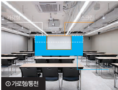
① 가로형/통천 규 격 | 가로 - 6(W) x 0.8(H) m 통천 - 6(W) x 2.5(H) m 설치 위치 | 스크린 뒤 설치 방법 | 바텐 자석 또는 케이블타이 고정 현수막 가공 | 현수막 재단, 현수막 하단 봉미싱
