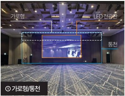
① 가로형/통천 규 격 | 가로 - 15.6(W) x 1.5(H) m 통천 - 15.6(W) x 6.4(H) m 설 치 위 치 | LED 전광판 앞 / 스크린 뒤 설 치 방 법 | 바텐 자석 또는 케이블타이 고정 현수막 가공 | 현수막 재단, 현수막 하단 봉미싱
